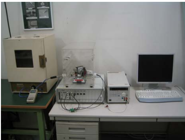
図 1 熱過渡特性解析システム概図
