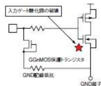
図6 GG-NMOS 保護トランジスタ保護回路
