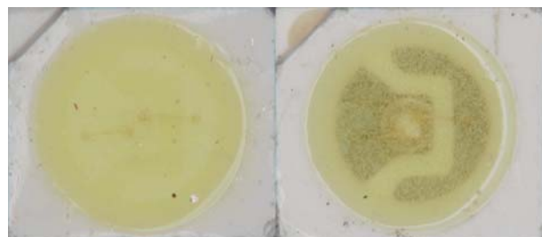
良品 不具合品 写真1 LED 良品、不具合品の光学顕微鏡像
