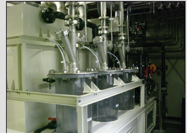
3チャンバータイプ(3:1) 処理流量:300L/min * 3 用途:クリーニング専用
