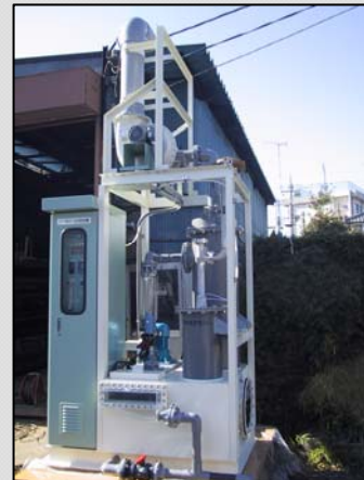
1チャンバータイプ(1:1) 処理流量:1,000L/min 用途:EPI装置
