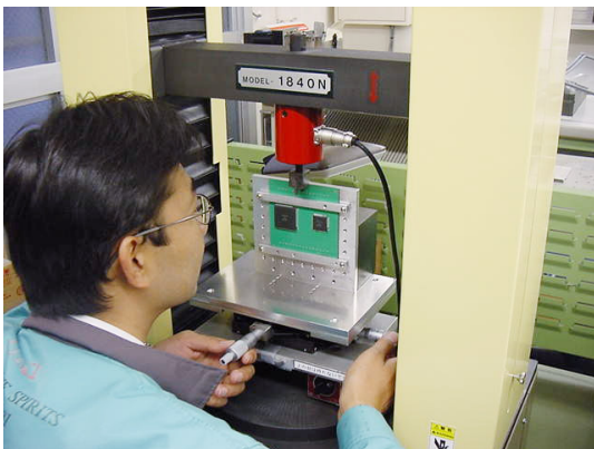
写真2 JIS Z 3198-7 鉛フリーはんだ試験方法 チップ部品のはんだ継手せん断試験方法
