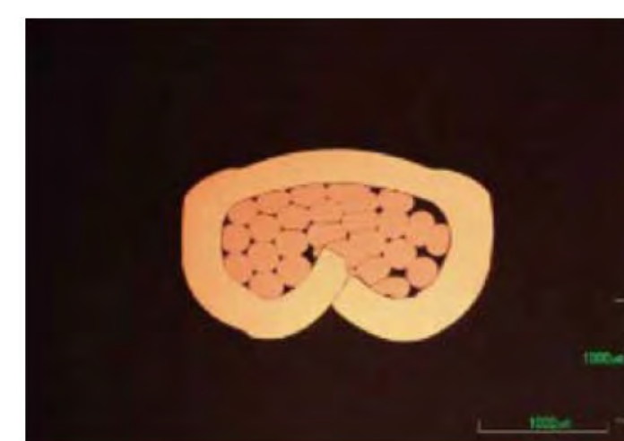
端子圧着部の断面観察例
