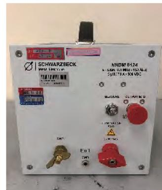
車載部品向け校正標準器例
