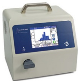
ナノスキャン（粒子径分布計測器） SMPS 3910 （TSI社製：東京ダイレック） 粒子測定範囲：10～420nm 濃度範囲： 1 \times 10^2 \sim 1 \times 10^5 個/cc
