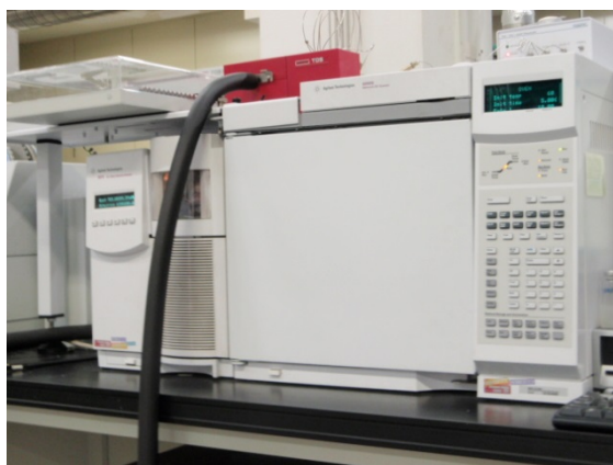
ガスクロマトグラフ質量分析装置 GC/MS(アジレントテクノロジー製)
