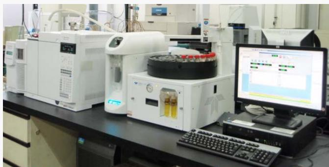
測定装置: アジレントテクノロジー GC/MS 5975C inert
