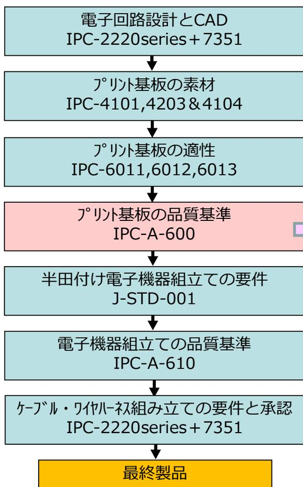
IPC（米国電子回路協会）では、電子製品の設計、購買から組立てにいたるまで、高い品質と信頼性、一貫性を確保できる標準（試験方法）を提供しています。その中で、プリント基板の品質基準について記載されているのが、IPC-TM-650 2.3規格です。
