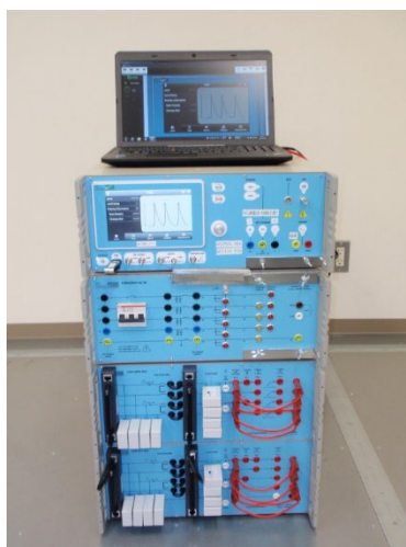
鉄道 EMC 規格対応イミュニティ複合試験器
