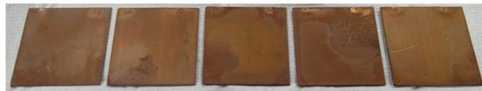
腐食性モニタ用銅試験片 試験後 (例)
