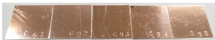
腐食性モニタ用銅試験片 試験前 (例)
