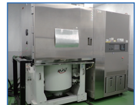
大型複合環境試験機外観
