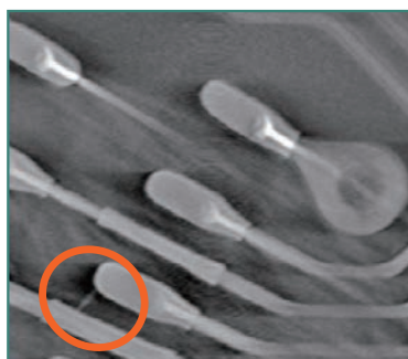
X線CT検査 (BGAデバイスの配線間ショート)
