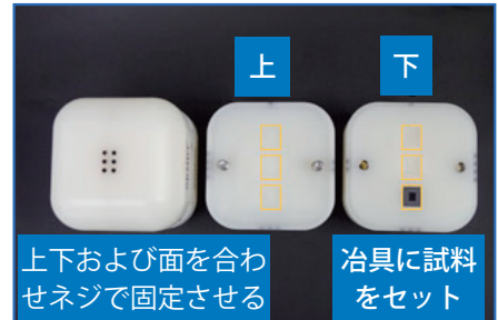
64mm角アダプタ治具に試料をセットした状態
