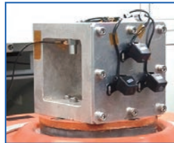
車載カメラ バンプ試験例
