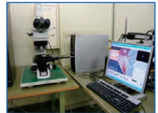
断面観察によるクラック調査
