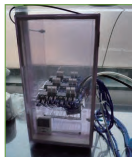
暴露試験槽 (例)
