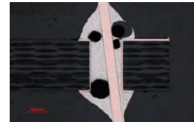
ボイド事例 (スルーホール断面)
