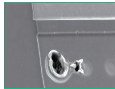
エッチバック界層解析検査 (接合破壊痕SEM像)
