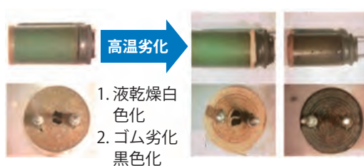
寿命試験後の劣化状態
