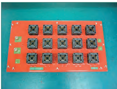
評価試験ボード例
