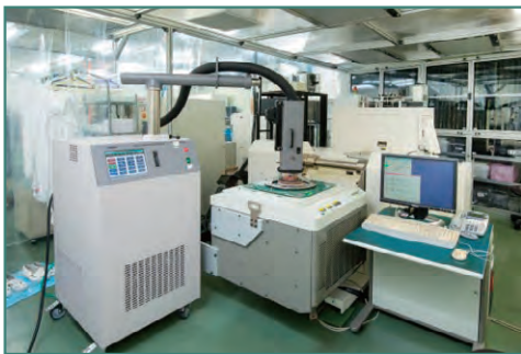
電気的特性試験装置外観 T6575およびサーモニクス
