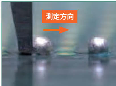
半田ボールシエア強度試験
