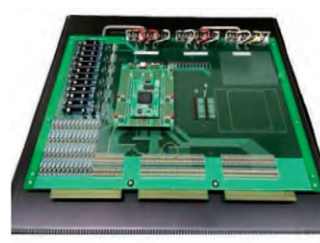
自社開発したメモリーデバイスの 信頼性試験用制御ボード
