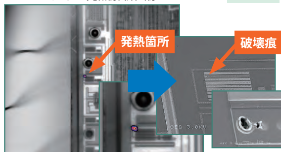
故障部位検出箇所の解析事例 [接合破壊痕]
