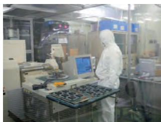
電気的特性試験環境外観 （クリーンブース保有）
