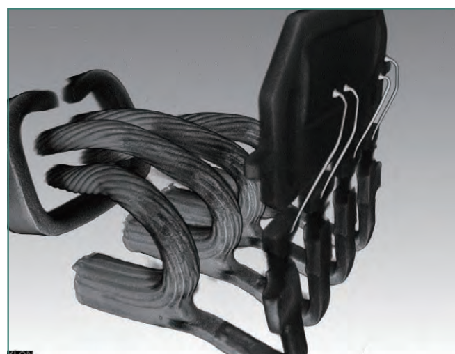
センサー部品 [加工画像による構造確認]
