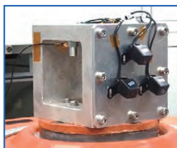
車載カメラ バンプ試験例
