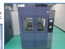
液槽熱衝撃試験機
