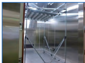
恒温恒湿室内部
