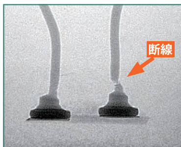
LEDのワイヤー接続部 [ワイヤー断線]
