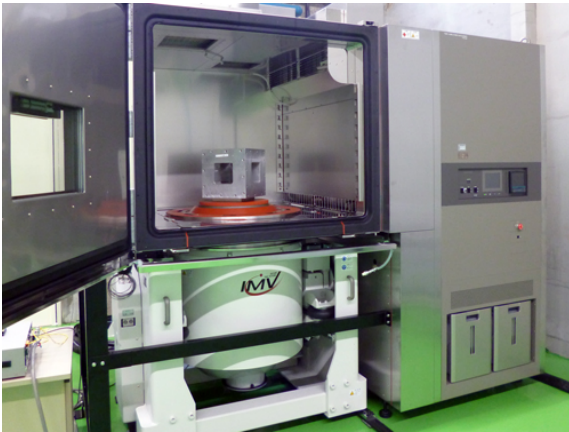
メーカー・型式 加振機：IMV EM2506 恒温恒湿槽：ESPEC PVS-5KPH
