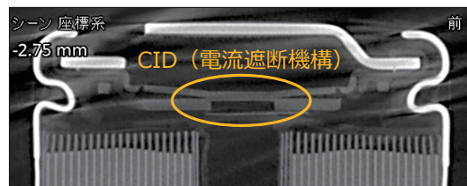
図. 電池AのX線CT像（+側）
