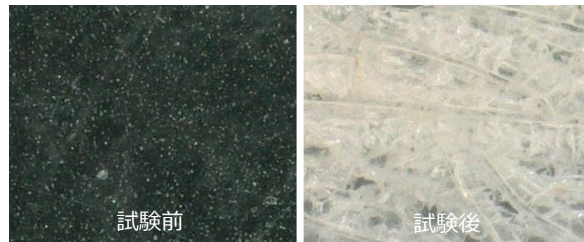
試料表面：クラックが全面に発生
