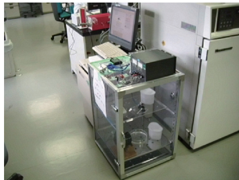
写真1 暴露試験槽例
