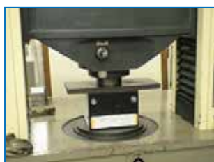
加圧破壊試験
