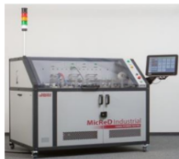
パワーサイクル試験装置 MicReD Power Tester 1500A (Mentor Graphics社製)
