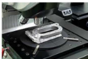
レーザー顕微鏡による アルミ腐食片の測定
