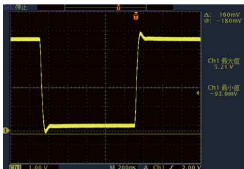
入力波形のオーバー/アンダーシュート約0.2V
