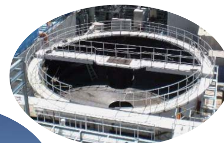
■ 排ガス処理装置 半導体製造等で排出される排ガス中の有害物質(シラン、TEOS、PFC、F等)を除去する装置
