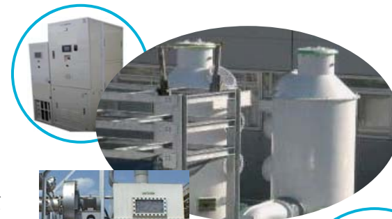
■ 界面活性剤リサイクル装置 半導体加工油、シリコン微粒子等を含んだシリコンウエハ洗浄機用界面活性剤を濾過再利用する装置
