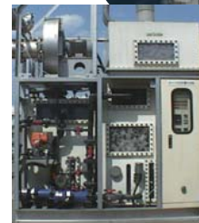
■ 排ガス処理装置 半導体製造等で排出される排ガス中の有害物質(シラン、TEOS、PFC、F等)を除去する装置
