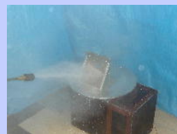
IPX9K 高圧洗浄試験例
