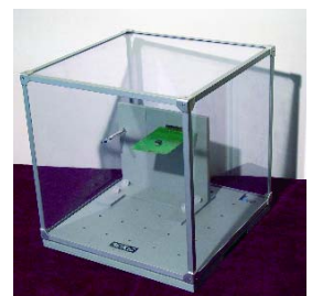
JEDEC標準エアチャンバー測定例
